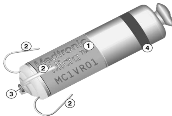
Rysunek 3. Rozrusznik bezelektrodowy Micra TPS MC1VR01
